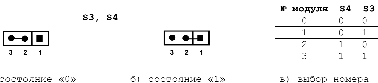
Рисунок 8.3 – Положение переключателей при выборе номера модуля RCDA NC110-35
